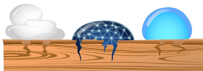
آب عامل ترکننده فوم اطفایی تصویر مایعات با کشش سطحی متفاوت
