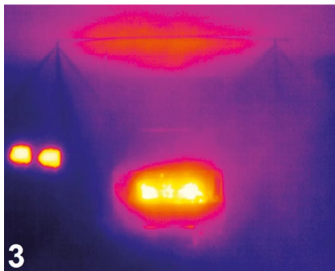
تصاویر حرارتی تست آتش‌سوزی خودرو با فعال‌سازی واترمپست
