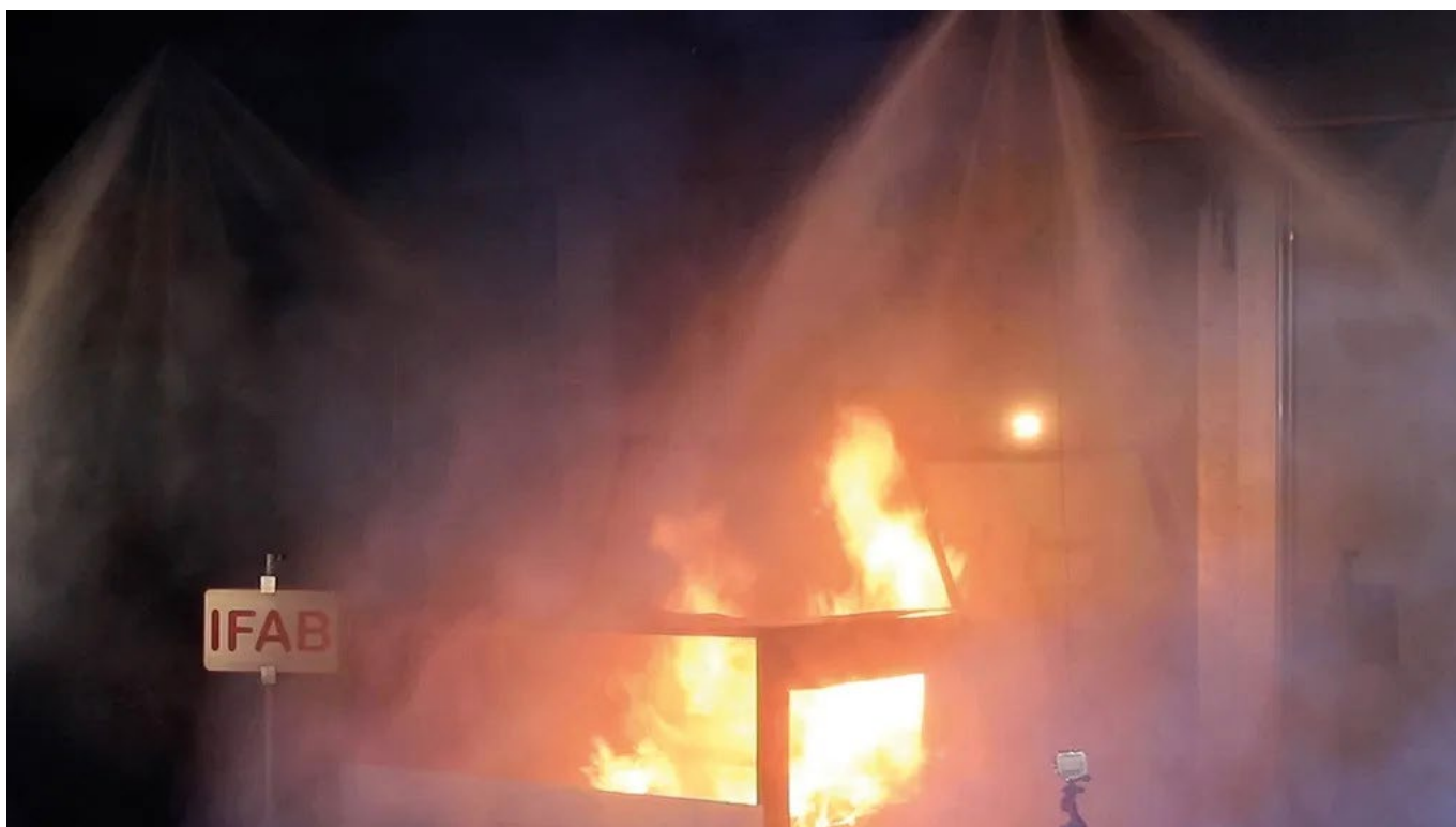
فعال‌سازی واترمیست در تست آتش‌سوزی SUVEREN با وسیله نقلیه الکتریکی
