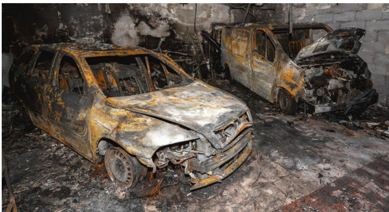
انتشار Thermal Runaway از سطح سلول به کل وسیله نقلیه
